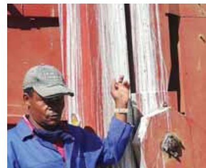
Ukuba umatshini wakho woku-vuna ugcinwe eshedini, beka izingxobo zeplastikhi okanye nokuba ungawugquma ngantoni ukuze uwukhusele kwilindle leentaka.
