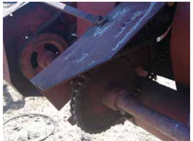
Qinisekisa ukuba onke amatsheyini agrisiwe ukuze angarusi.
