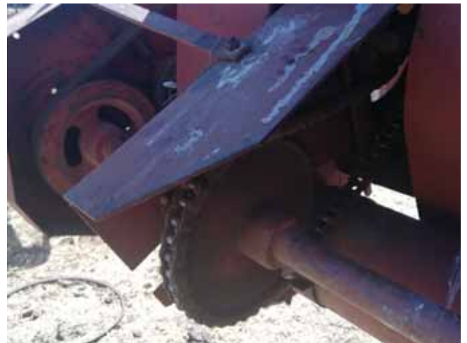
Netefatsa gape gore diketane tsotlhe di tshasiwe kerisi go thibela rusu.
