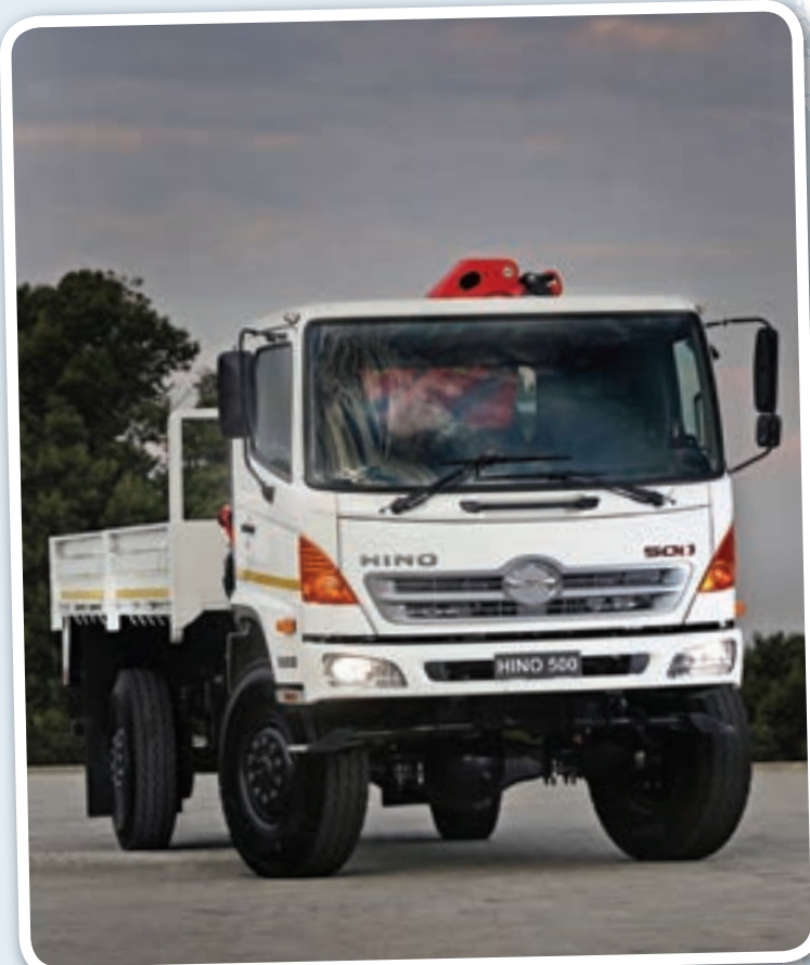
▲ Die Hino 1322 4x4-model in die 500-reeks het nou enkelagterwiele en 'n spoedbeperker.
