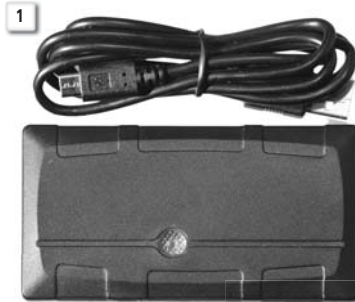
1: Die Ctrack BX600-model het 'n kragtige interne batterystel en kan herlaai word danksy die mikro-USB-kabel en kompakte herlaaier wat saam met die toestel verskaf word.
