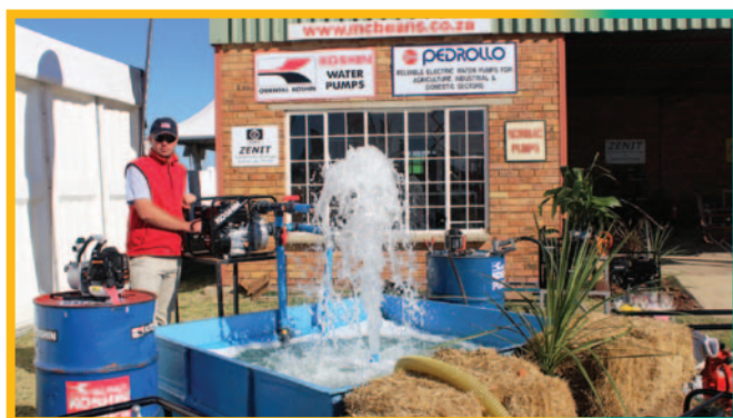
▲ André Grobler van McBean's, met takke in Pietermaritzburg, Johannesburg en Kaapstad, wys hul Duitse Koshin-hoëdrukpomp. Dit is dieselenjin-aangedrewe, sterk en lig, maar steeds hoogs doeltreffend. Dit kan vir byvoorbeeld besproeiing of brandbestryding gebruik word. Davey/Honda, Sinopower en Normac/Honda is die ander handelsmerke in McBean's se reeks enjin-aangedrewe pompe.
