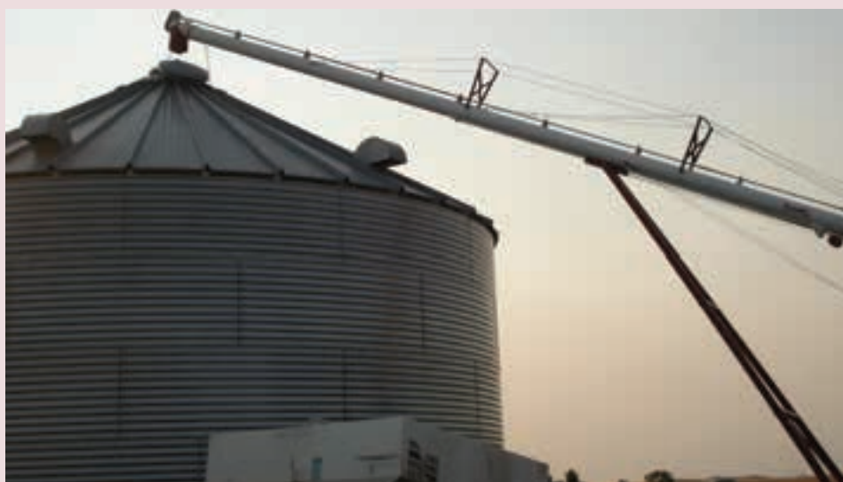
Dragbare awegaars maak die baie makliker om groot hoeveelhede graan op 'n slag te hanteer.
