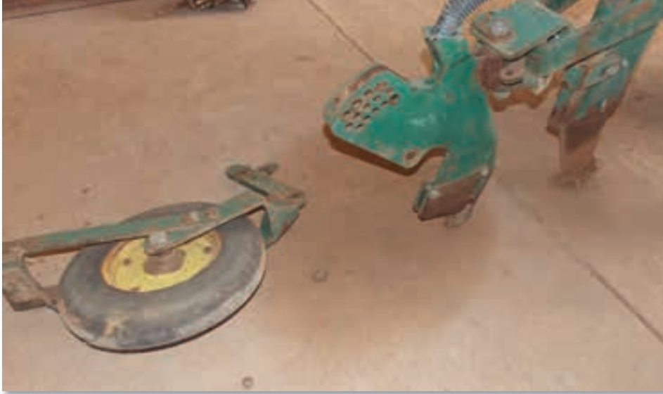
Die wiel is afgehaal om die wiellaers wat uitgewerk is, te vervang.
