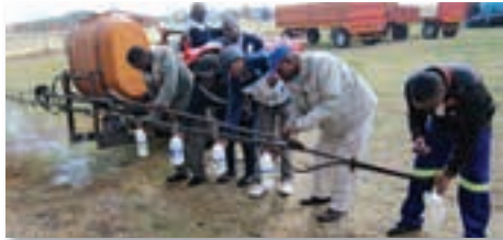
Peakanyo (calibration) ya segašetši sa "boom" e bohlokwa kudu go kgonthiša tirišo ye e nepagetšego ya dikhemikhale.
