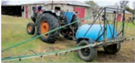
Segašetši sa "boom" seo se dirišwago go laola mengwang ka dikhemikhale.
