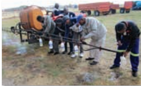
Die kalibrasie van 'n onkruidspuit is baie belangrik om die korrekte dosis chemikalieë wat toegedien word, te verseker.
