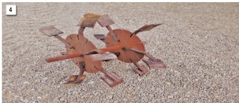
▲ 4: Die oorspronklike ontwerp van die lemskywe wat heelwat meer werk as die finale ontwerp geveerg het.
